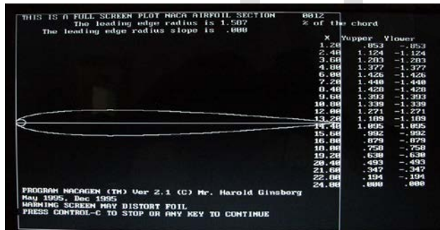
Fig. 2.1 Blade Profile NACA 0012.
