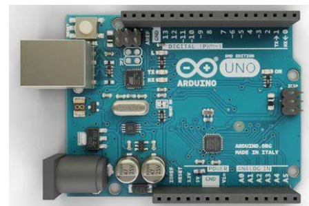
Figure 2. Arduino UNO Microcontroller
